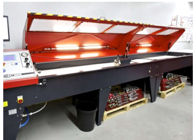
Bild 2: Druck- und Dichtigkeitsprüfstand für Hydraulik-Schlauchleitungen mit geöffneter trennender Schutzeinrichtung
