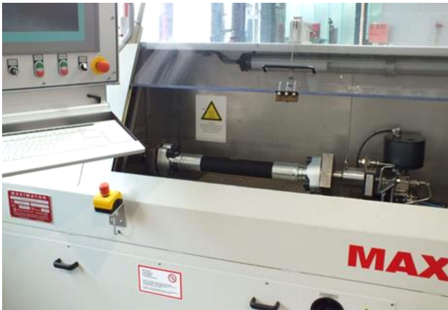
Bild 1: Berstdruckprüfstand mit geöffneter trennender Schutzeinrichtung
