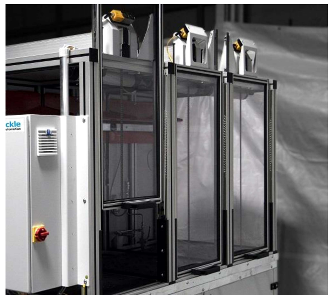
Bild 6: Geöffnete trennende Schutzeinrichtungen an einem Hydraulik-Prüfstand
