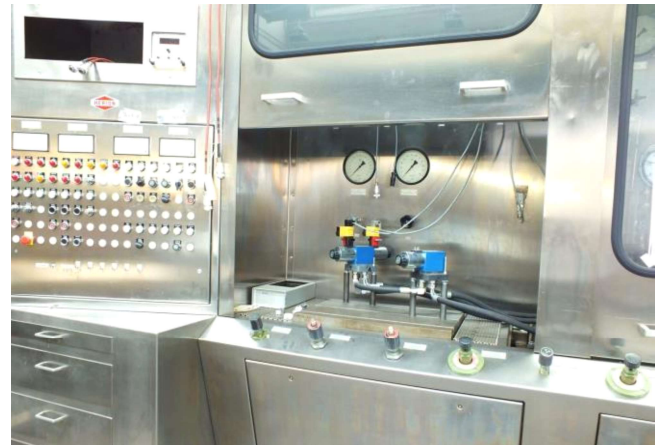
Bild 3: Hydraulischer Komponentenprüfstand mit geöffneter trennender Schutzeinrichtung
