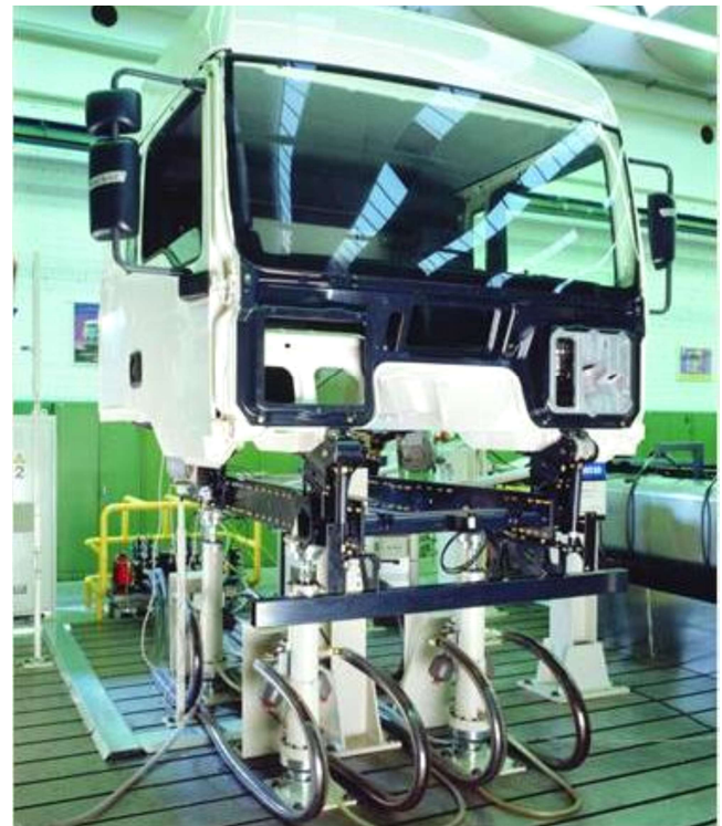
Bild 9: Servozylinder für hochdynamische Simulation von Bewegungen in separatem Prüfraum
