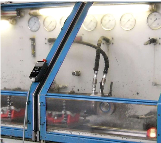
Bild 5: Hydraulischer Zylinderprüfstand mit geschlossener trennender Schutzeinrichtung
