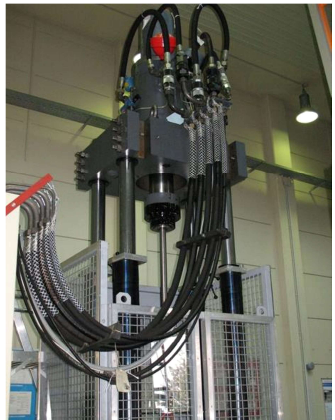
Bild 4: Hydraulischer Prüfstand für Zugversuche mit geschlossener trennender Schutzeinrichtung mit Polycarbonat-Sichtscheiben
